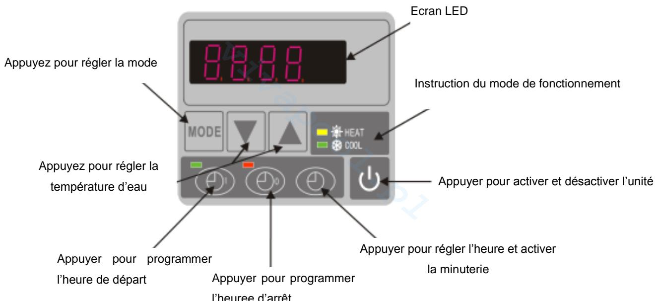
Lorsque la pompe à chaleur est en cours de fonctionnement, l'écran LED affichera la température d'arrivée d'eau.
