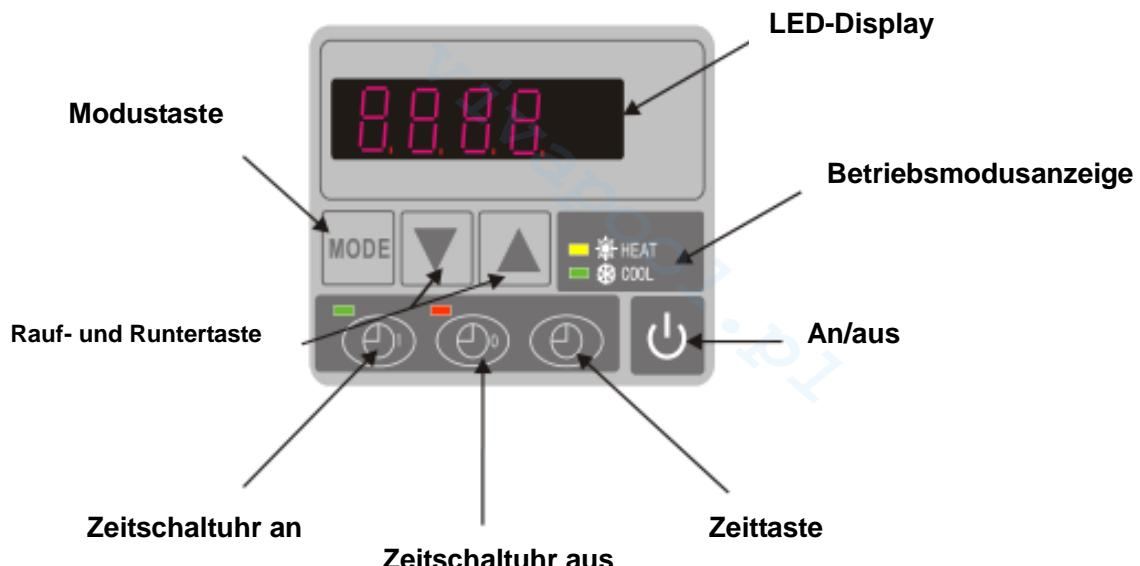
Wenn die Wärmepumpe läuft, dann zeigt der LED Bildschirm die Wassereintrittstemperatur.
