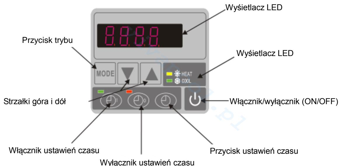
Gdy pompa grzewcza jest włączona, wyświetlacz ciekłokrystaliczny LED wskazuje temperaturę wody dopływającej.
