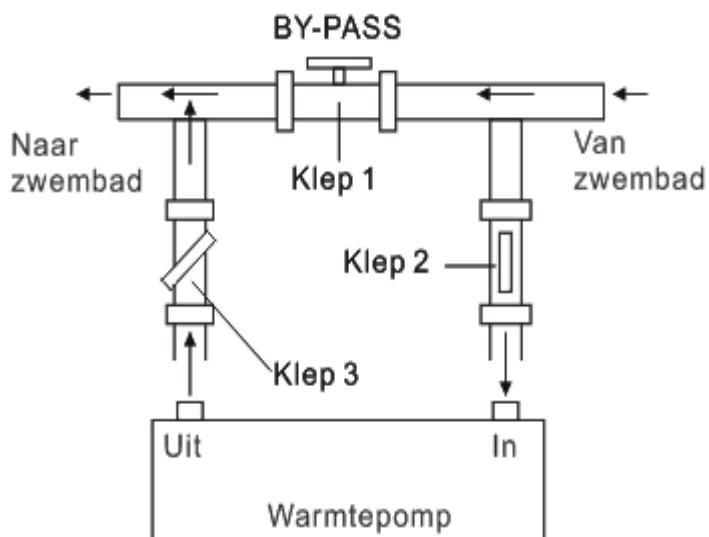
Gebruik de volgende procedure om de bypass bij te stellen:
